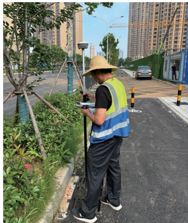
武汉市蔡甸区排水管网精细化排查项目部成员正在收测管线点
